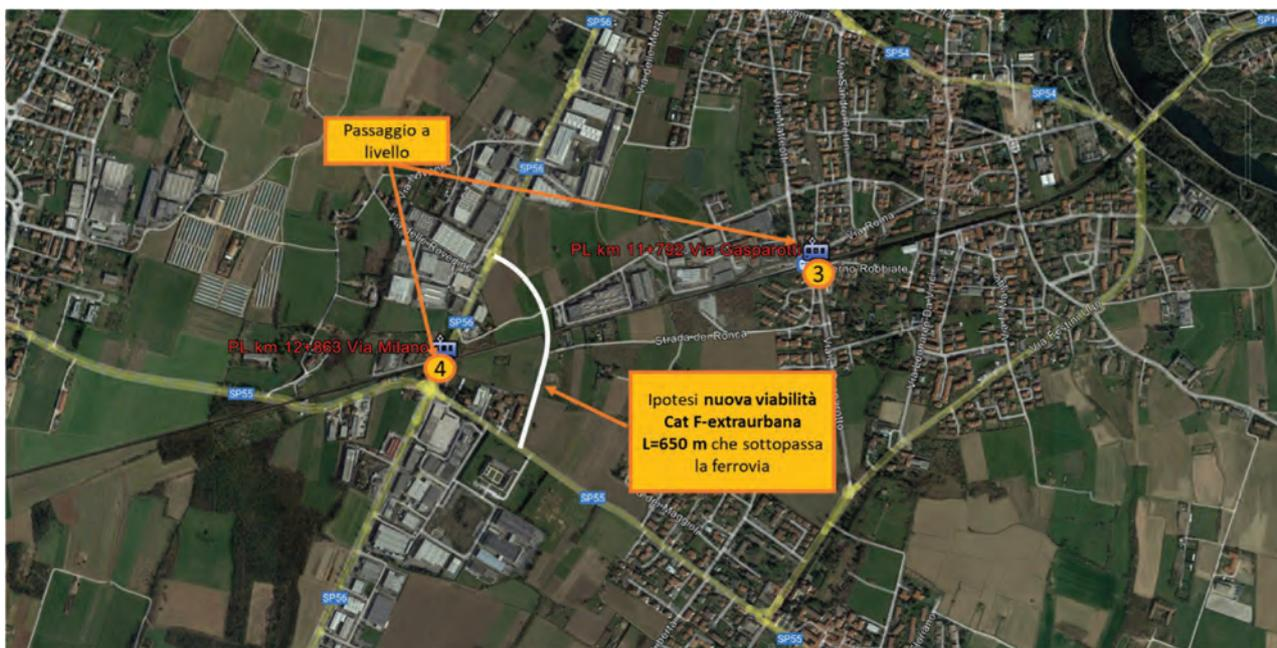
La viabilità è una strada di tipo F-extraurbana con corsie da 3,50 m che permettono la circolazione di tutte le tipologie di mezzi definiti dal paragrafo 3.4.2 del D.M. 5/11/2001.
