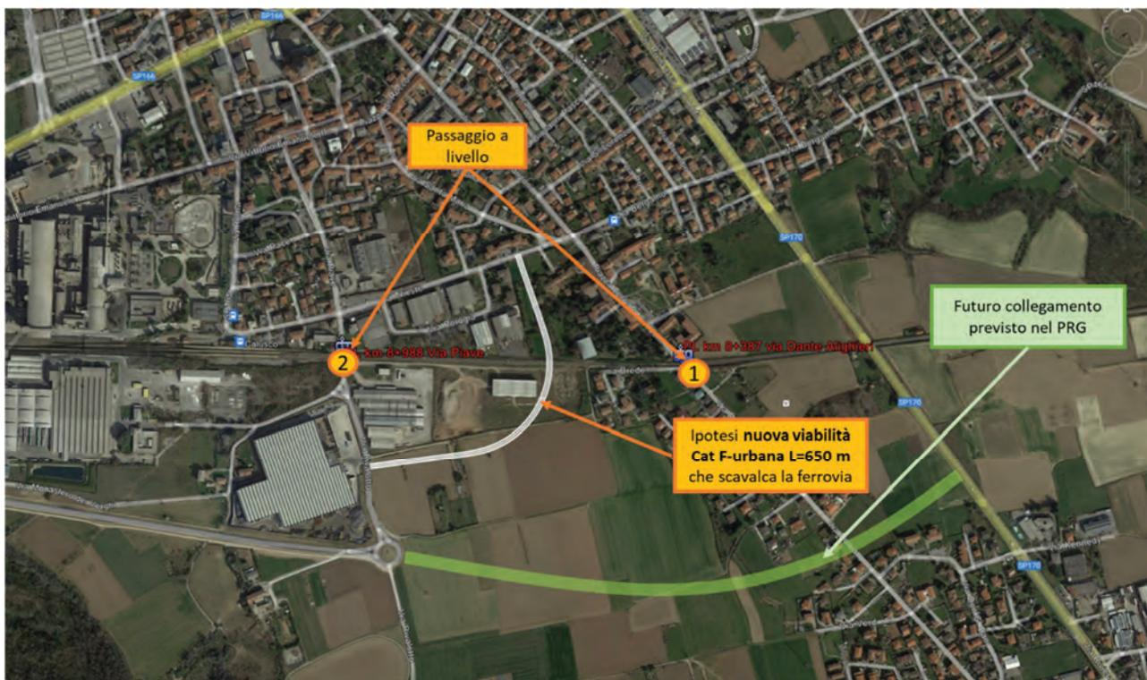
La viabilità è una strada di tipo F-urbana con corsie da 3,50 m che permettono la circolazione di tutte le tipologie di mezzi definiti dal paragrafo 3.4.2 del D.M. 5/11/2001.
