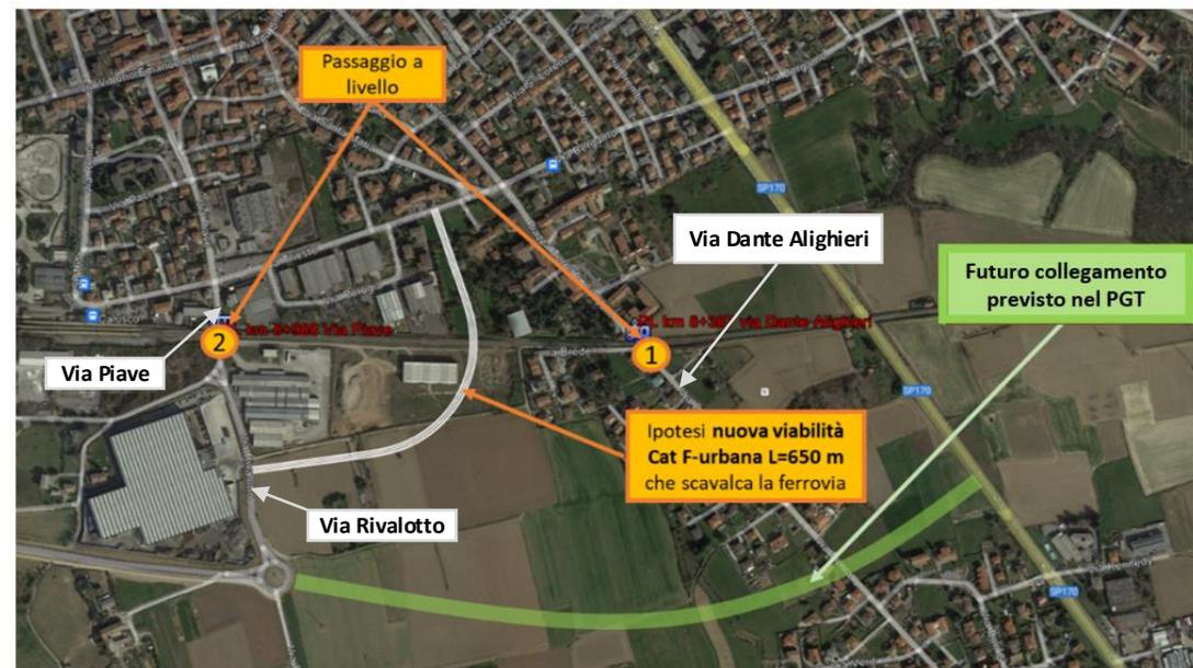
Il corridoio proposto è compatibile anche con un sottopasso: nelle successive fasi progettuali verrà valutata la compatibilità idraulica e adottata la soluzione preferibile
